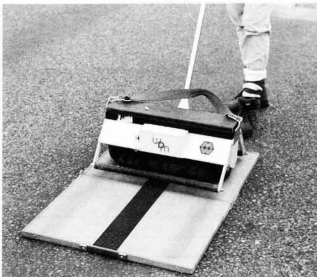
Figure 8 - Calibrating the Mini Texture Meter
